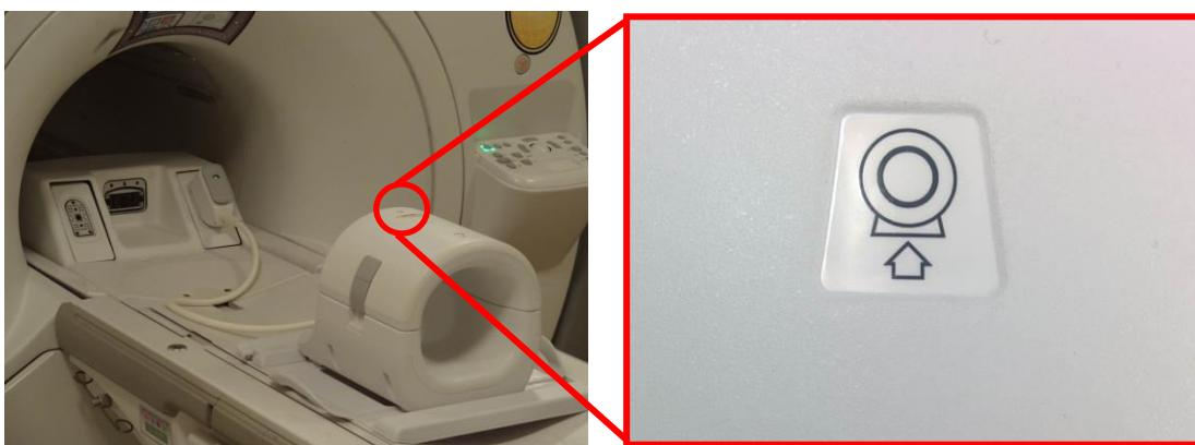
4. Conectați conectorul bobinei la portul de emisie al sistemului. (Consultați manualul utilizatorului pentru detalii privind amplasarea portului TR) Întoarceți conectorul P-Port astfel încât să arate poziția BLOCAT (vezi imaginea din dreapta).
