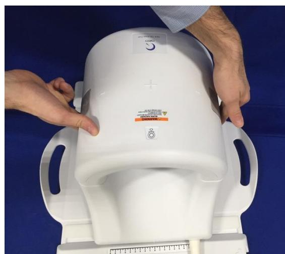
4. După ce ați poziționat partea anterioară a bobinei, împingeți clapetele de blocare de pe părțile laterale ale bobinei, apăsând înspre suprafața bobinei, pentru a actiona mecanismele de blocare. Dacă clapetele nu sunt complet închise, bobina se poate decupla în timpul examinării
