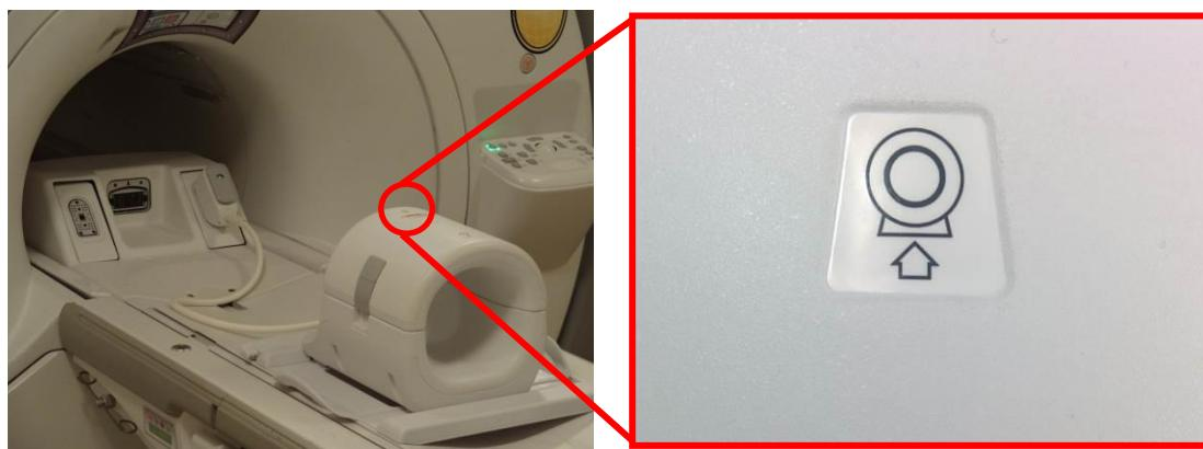
5. Conectați conectorul bobinei la portul de emisie al sistemului. (Consultați manualul utilizatorului pentru detalii privind amplasarea portului TR) Întoarceți conectorul P-Port astfel încât să arate poziția BLOCAT (vezi imaginea din dreapta).
