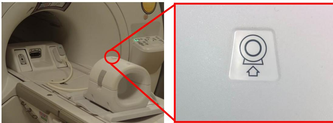
5. Pripojte konektor cievky do vhodného portu prenosu systému. (Informácie o umiestnení portu TR nájdete v používateľskej príručke systému) Otočte koniec konektora P-Port tak, aby sa nachádzal v polohe UZAMKNUTÝ, pozrite si obrázok vpravo.
