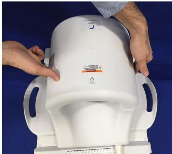
4. Kada se spoljni deo u potpunosti zatvori, pritisnite krilca preklopne brave sa obe strane ka površini kalema da bi se brava zatvorila do kraja. Ako se preklopna brava ne zatvori u potpunosti, kalem može da se isključi tokom skeniranja i dovede do potpunog ili
