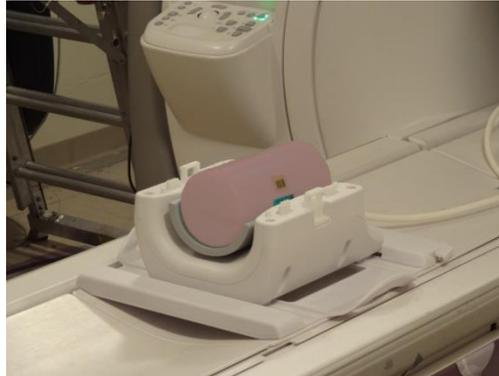
10. Ponovo pričvrstite spoljnu polovinu kalema. Uverite se da su dve polovine u potpunosti sklopljene i da su oba krilca preklopne brave vraćena.
