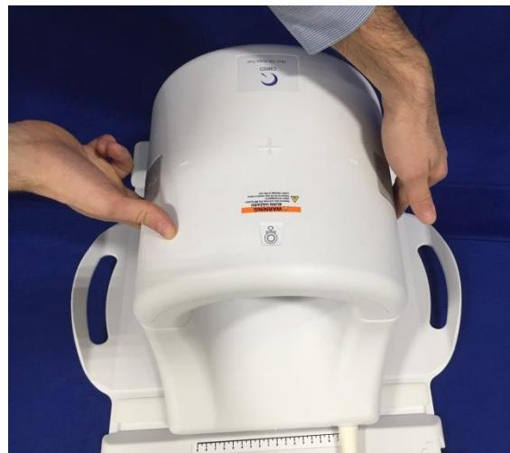
4. Khi nửa trên của cuộn được đóng hoàn toàn, đẩy chốt khóa hai bên xuống theo bề mặt cuộn để đảm bảo thiết bị được cài chốt hoàn toàn. Trong trường hợp các chốt không được khóa chặt, cuộn có thể tách rời trong quá trình chụp khiến hai nửa cuộn bị mất kết nối hoàn toàn hoặc ngắt quãng, dẫn đến chất lượng hình ảnh kém hoặc làm hỏng cuộn.
