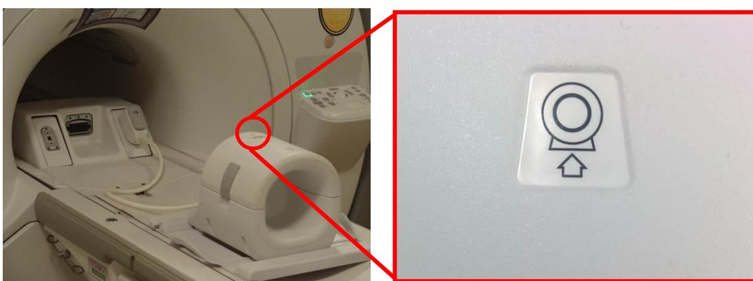
4. 将线圈连接器连接到系统的相应发射端口。（有关 TR 端口位置，请参阅系统用户手册。）将 P 端口连接器的末端转过来，以便使其显示“锁定”位置，请参见右图。
