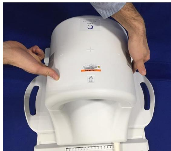
4. 前半部分完全闭合后，将两侧的闩锁翼片向下推靠在线圈表面，以便完全啮合机械闩锁。如果闩锁未完全啮合，则在扫描过程中线圈可能会脱离，并且可能导致线圈两半部分之间的连接完全中断或断断续续，这将导致影像质量差或线圈受损。
