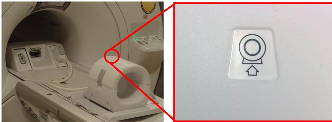
5. 将线圈连接器连接到系统的相应发射端口。（有关 TR 端口位置，请参阅系统用户手册。）将 P 端口连接器的末端转过来，以便使其显示“锁定”位置，请参见右图。
