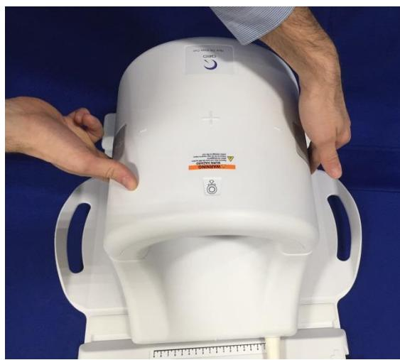
4. Jakmile se zcela zavře horní polovina, stlačte aretační jazýčky dolů na obou stranách proti povrchu cívky, aby se zcela zavřely mechanické západky. Pokud nebudou západky zcela zavřené, cívka se může během skenování otevřít a způsobit celkovou ztrátu spojení nebo přerušované spojení mezi polovinami cívky, což má za následek špatnou kvalitu obrazu nebo poškození cívky.
