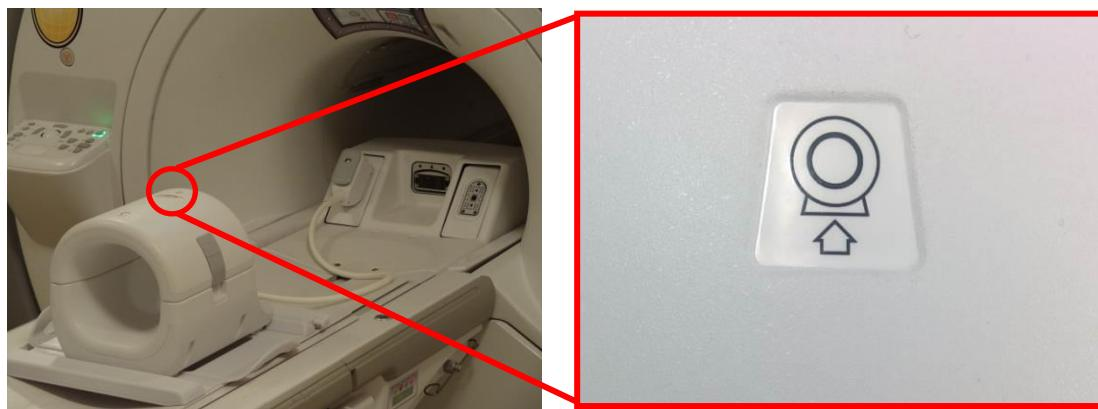
5. Tilslut spolestikket til den relevante sendeport på systemet. (Se systemets brugervejledning vedr. placering af TR-port) Drej enden af P-portens stik rundt, så det viser positionen LOCKED (låst). Se billede til højre.
