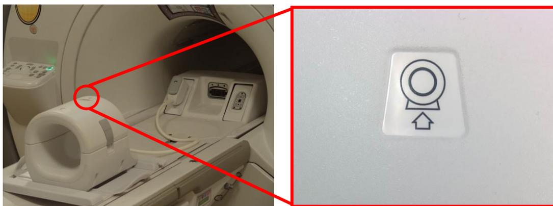
5. Collegare il connettore della bobina alla porta di trasmissione del sistema appropriata (vedere il manuale dell'utente del sistema per la posizione della porta di trasmissione/ricezione). Ruotare l'estremità del connettore della porta P in posizione di BLOCCO come mostrato nell'immagine a destra.
