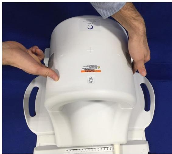
4. После надлежащей установки верхней части катушки вдавите защелки с обеих сторон в направлении к поверхности катушки, чтобы обеспечить надежное механическое соединение. Если защелки полностью не закрыты, катушка может отсоединиться в процессе сканирования и привести к полной или частичной потере соединения между
