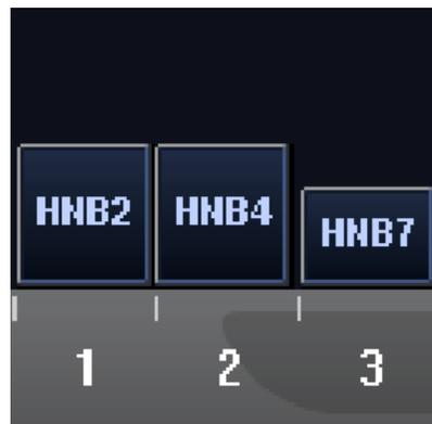
Se la scansione con Atlas SPEEDER Head/Neck e altre bobine viene eseguita contemporaneamente, la sezione 2 (HNB2) non deve essere selezionata. Il SNR viene ridotto se la scansione viene eseguita con questa sezione selezionata.
