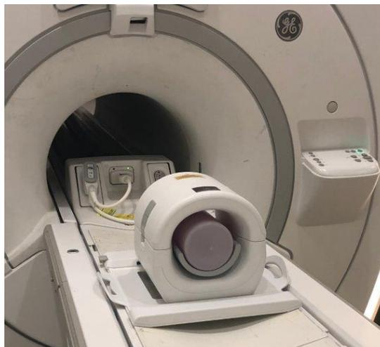
10. Setzen Sie die vordere Spulenhälfte wieder ein. **Achten Sie darauf, dass die beiden Hälften vollständig geschlossen und die Riegellaschen eingedrückt sind.**
