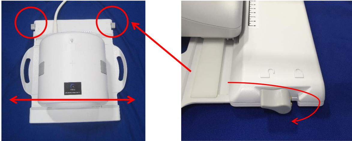
8. Trennen Sie die vordere Spule, indem Sie gleichzeitig an den Riegellaschen ziehen, bis die beiden Hälften vollständig voneinander getrennt sind.
