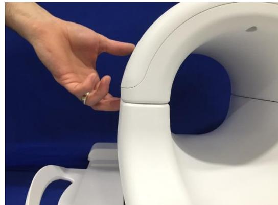
9. Coloque o apoio inferior de 0,5" (1,27 cm) na bobina de joelho QED T/R (5561409-8) e o fantoma unificado cilíndrico grande, o SiOil (5342679-2) na bobina, conforme apresentado abaixo.
