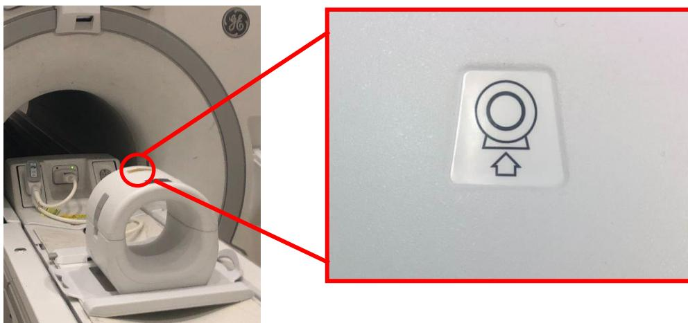
4. Подключите штекеры катушки к соответствующим разъемам на системе. (Расположение разъема указано в руководстве пользователя системы.) Переверните конец разъема P-Port так, чтобы он соответствовал ЗАФИКСИРОВАННОМУ положению, как показано на рисунке справа.
