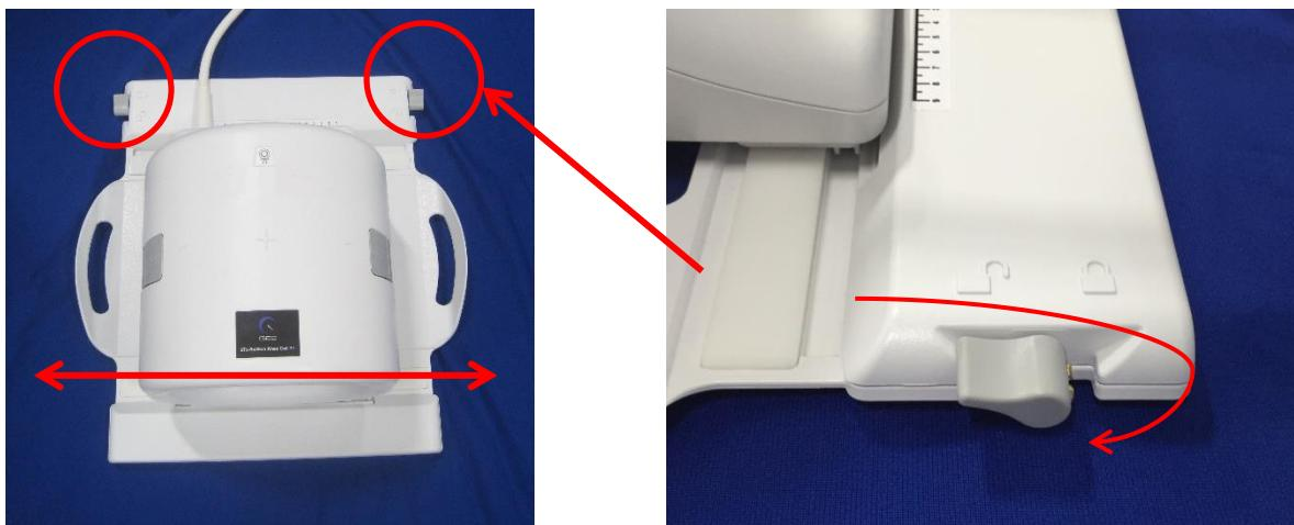
7. Отделите верхнюю часть катушки, потянув за обе защелки одновременно таким образом, чтобы половинки полностью отсоединились друг от друга.
