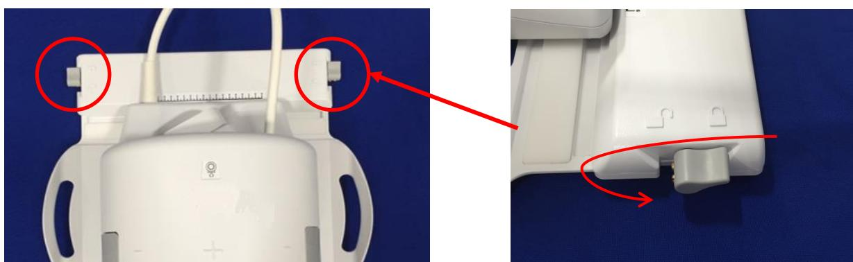
7. После установки катушки в нужное положение верните ручку в зафиксированное положение, чтобы закрепить катушку на месте.
