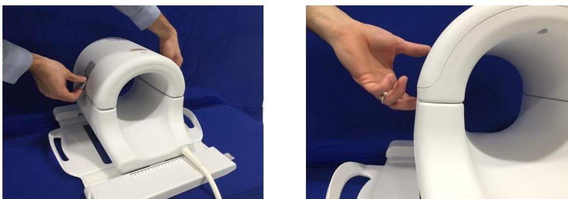
9. Поместите нижнюю накладку 0,5 дюйма (5561409-8) для катушки T/R QED для проведения МРТ колена и большой цилиндрический унифицированный фантом, SiOil (5342679-2) на катушку, как показано ниже.
