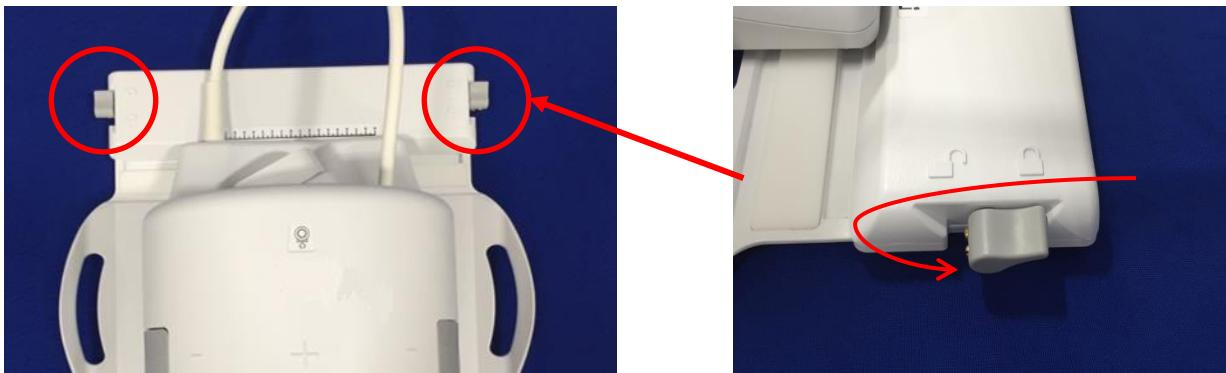
6. После установки катушки в нужное положение верните ручку в зафиксированное положение, чтобы закрепить катушку на месте.
