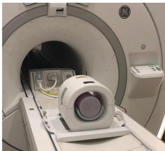
10. Ponovo pričvrstite anteriornu polovinu kalema. **Uverite se da su dve polovine u potpunosti sklopljene i da su oba krilca preklopne brave vraćena.**
