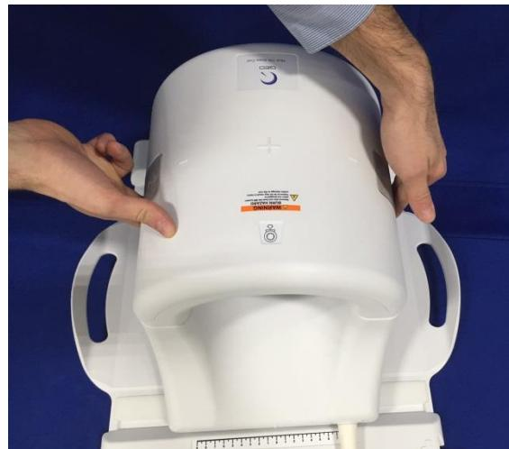
4. 前半部分完全闭合后，将两侧的闩锁翼片向下推靠在线圈表面，以便完全啮合机械闩锁。如果闩锁未完全啮合，则在扫描过程中线圈可能会脱离，并且可能导致线圈两半部分之间的连接完全中断或断断续续，这将导致影像质量差或线圈受损。
