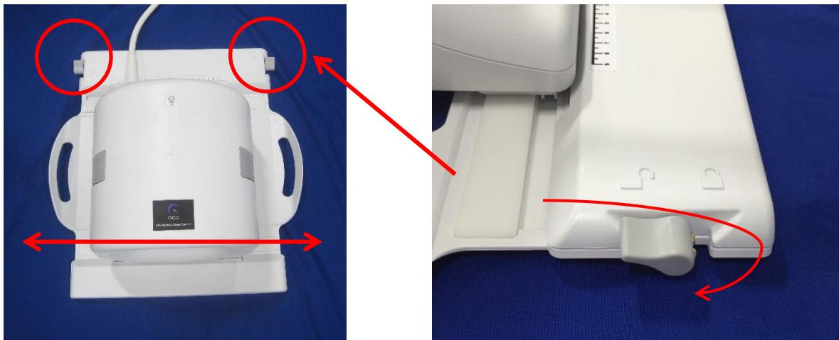
8. 同时拉动两个闩锁翼片，直到两个部分完全脱离为止，将前线圈分开。
