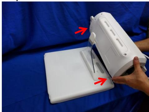
Installieren Sie die Spule dann in der gewünschten Ausrichtung, indem Sie die Spule mit der Spulenhalterung ausrichten und in Richtung der Halterung drücken, bis die Spule in der Spulenhalterung einrastet, wie unten gezeigt.
