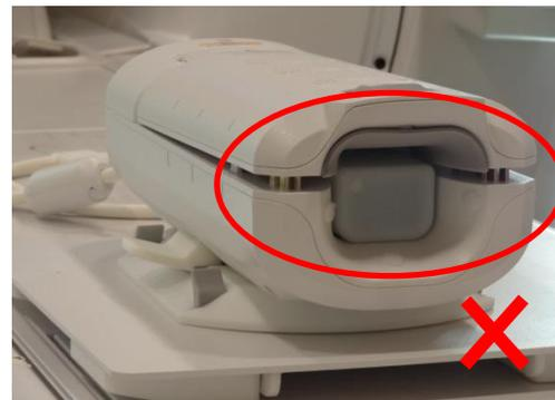
12. Vergewissern Sie sich, dass sich die Markierung der Spule in die mittigsten Markierung befindet, wie unten dargestellt, und bewegen Sie die Spule in das Isozentrum.
