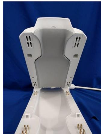
10. Setzen Sie das vereinheitlichte kubische Phantom (5342681) in die Spule, wie im Folgenden dargestellt. **Stellen Sie sicher, dass die Unterkante des Phantoms auf die FOV-Markierungen auf der Spule ausgerichtet ist.**
