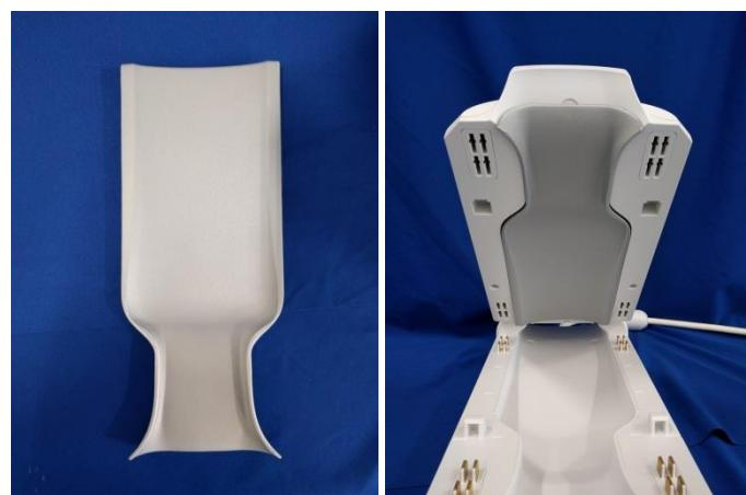
10. Τοποθετήστε το ενοποιημένο κυβικό ομοίωμα (5342681) μέσα στο πηνίο όπως απεικονίζεται παρακάτω. Βεβαιωθείτε ότι η κάτω πλευρά του ομοιώματος ευθυγραμμίζεται με τις ενδείξεις οπτικού πεδίου στο πηνίο.
