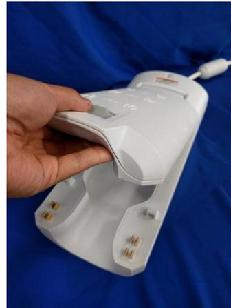
9. Placez le support de doublage supérieur (3004566) sur la moitié supérieure de l'antenne.
