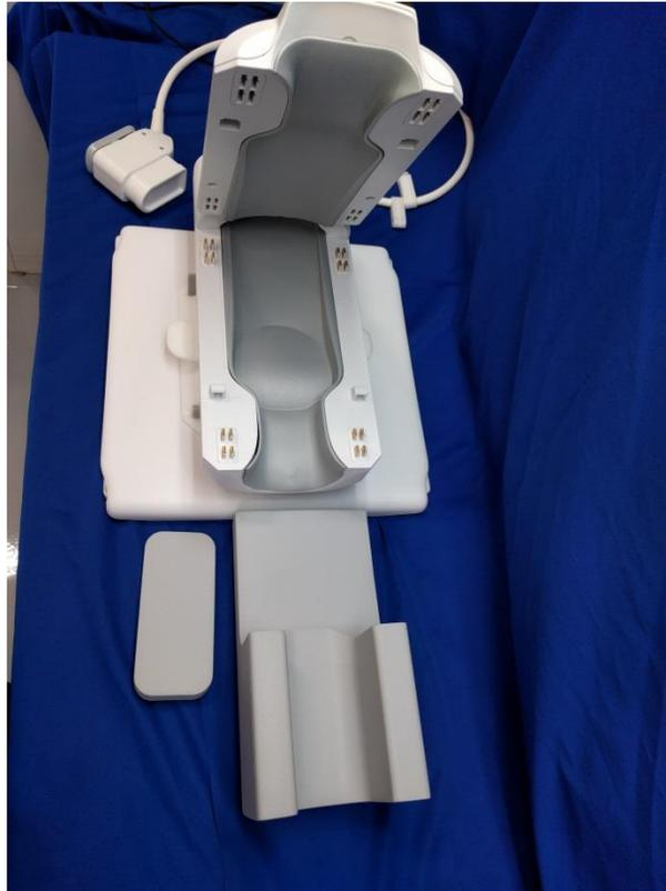
2. Positionnez la main du patient dans l'antenne. Utilisez les repères sur l'antenne pour faciliter le positionnement comme illustré ci-dessous. Si nécessaire, utilisez des cales et/ou des supports de paume pour immobiliser la main/le poignet du patient et assurer son confort.
