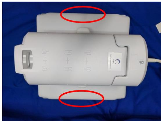
3. Placez l'antenne sur la table d'examen. Notez que la flèche de direction du tunnel illustrée ci-dessous doit pointer **vers** le tunnel.
