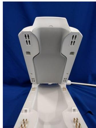
10. Placez le fantôme cubique unifié (5342681) dans l'antenne comme indiqué ci-dessous. **Vérifiez que le bord inférieur du fantôme est aligné avec les marquages FOV sur l'antenne.**
