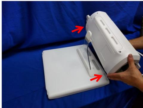
Ensuite, installez dans l'orientation souhaitée en alignant l'antenne avec le support d'antenne et en poussant vers le support jusqu'à ce que l'antenne se verrouille dans le support d'antenne, comme illustré ci-dessous.
