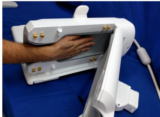
Untuk mengubah orientasi, sambil memegang gelang, tekan tuas pelepas gelang dengan kuat, seperti yang ditunjukkan pada masing-masing pelat dasar di bawah ini:
