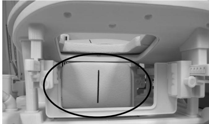
(13) Deslice el soporte de la rejilla con la rejilla medial dentro del soporte de la bobina lateral y empújelo hasta que haga clic. Repita esto mismo en el otro lado. Confirme visualmente que los soportes de la rejilla de ambos lados estén bloqueados en su sitio.
