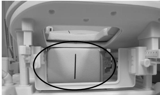
(13) Faites glisser le porte-grille avec la grille médiale dans le support d'antenne latérale et poussez jusqu'à ce qu'il s'enclenche. Répétez cette opération de l'autre côté. Vérifiez visuellement que les supports de grille des deux côtés sont verrouillés en place.
