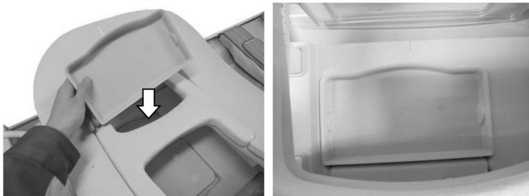
(12) Si le sein qui n'est pas imagé interfère avec l'imagerie, placez une plaque de blocage avec un support de confort dans l'ouverture prévue pour ce sein.
