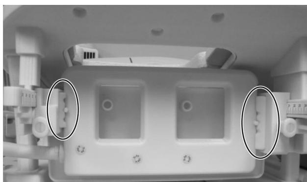
**Si nécessaire, retirez l'antenne latérale et réinstallez-la dans la position la plus basse**
