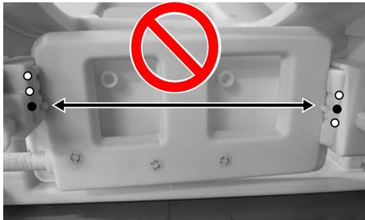
2. Si l'antenne latérale est installée dans la position verticale médiane ou la plus élevée, le mouvement horizontal sera limité.
