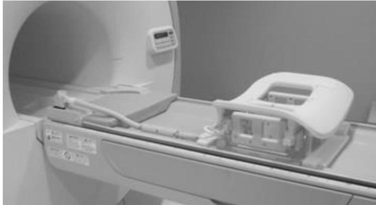
(3) Déverrouillez les quatre languettes de verrouillage en les abaissant comme illustré ci-dessous.
