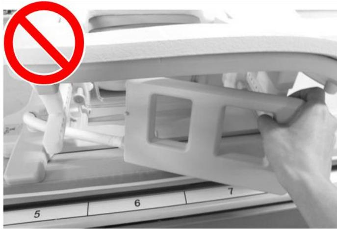
2. Quando si sposta la paziente nel gantry, verificare che le bobine laterali siano posizionate sul telaio o sul piano del lettino. Se le bobine laterali rimosse si trovano nello spazio tra il piano del lettino e il gantry, la bobina laterale potrebbe essere catturata dal piano del lettino durante il movimento.
