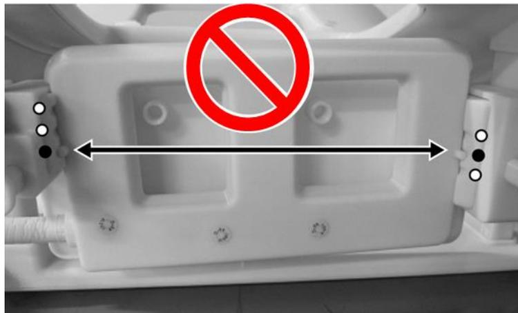
2. Se a bobina lateral for instalada na posição vertical média ou alta, o movimento horizontal será limitado.
