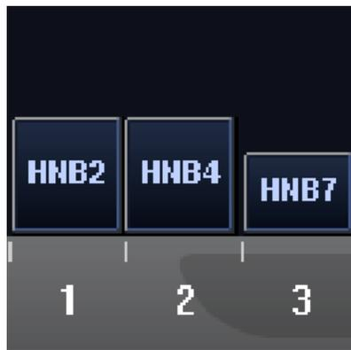
Se os exames forem realizados em simultâneo com a Atlas SPEEDER Head/Neck e outras bobinas, a secção 2 (HNB2) não deve ser selecionada. Se o exame for realizado com esta secção selecionada, a SNR diminui.
