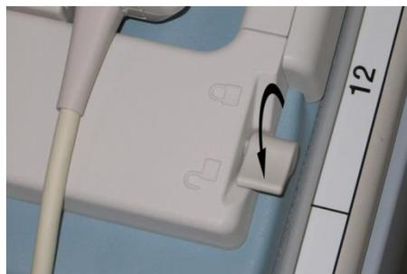
b. Ajuste la posición de la bobina deslizando hacia la izquierda o la derecha.
