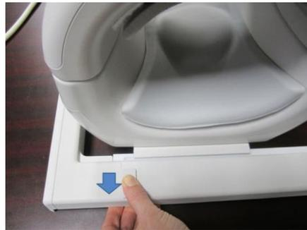
**Schritt 3: Schieben Sie die Spule über den Anschlag hinaus an die gewünschte Position.**
