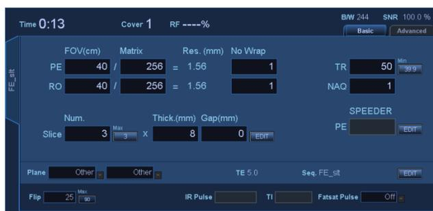
FE\_sl、特別プラン (体軸: 1、矢状: 1、冠状: 1)、TR50、NS3、ST8 mm、Flip25、FOV : 40 cm、MTX: 256 × 256、NoWrap (巻き付けなし) RO1.0/PE1.0
