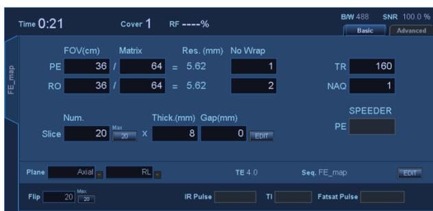
マップ、AX:RL、TR160、NS20、ST 8 mm、FA20、FOV 36 cm、MTX 64 × 64、NoWrap (巻き付けなし) RO2.0/PE1.0 表示された矢状スライスに 2 つのファントムが含まれるように位置づけを行います。
