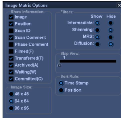
3. Die Bilder, die mit einer geraden Scan-ID im Bildmatrix-Fenster angezeigt werden, sind Zwischenbilder.
