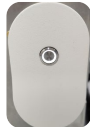
Encendido (la luz está encendida)
